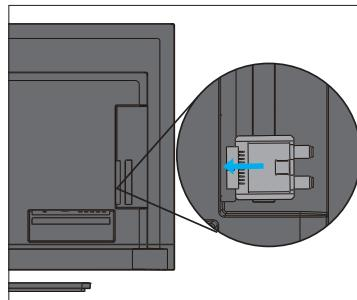
2. 視訊盒插入安裝槽後蓋上視訊盒擋板(圖示淺灰色)固定，注意中間的洞，並使用十字螺絲起子和剛拆下的螺絲，將視訊盒擋板(圖示淺灰色)鎖緊固定在顯示器上。
