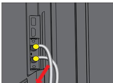
4. 視訊盒上有兩個接頭：一接頭為連接到傳統的類比有線電視用，另一接頭為連接數位電視天線輸入之用。將有線電視電纜連接到類比輸入接頭，並將您府上的數位電視天線電纜連接至數位輸入接頭，請確認連接是否牢固。接著請讓顯示器掃描與記憶電視頻道。
